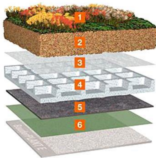
Abbildung 5: Schichtaufbau einer extensiven Dachbegrünung [20]
